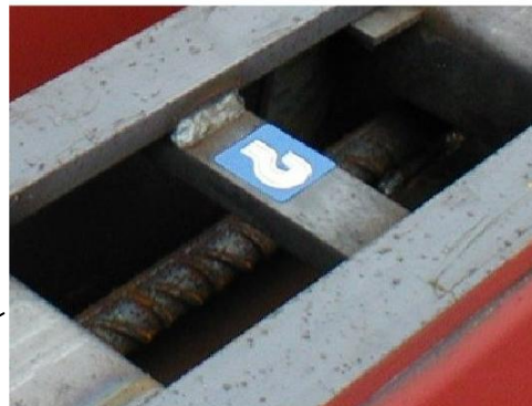
Lyftstagen är markerade med en blå-vit klisterlapp i form av en krok
