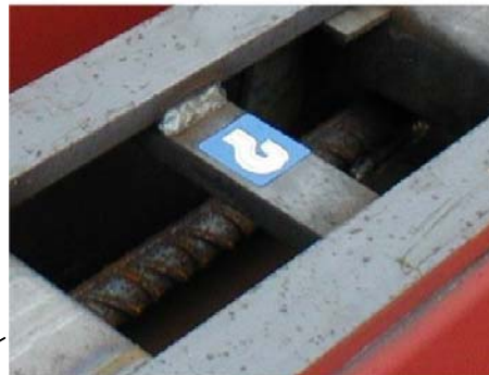
Die Hebepunkte sind durch einen Blau-Weißen Klebezettel markiert
